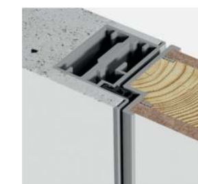
Монтаж коробки внутреннее открывание
